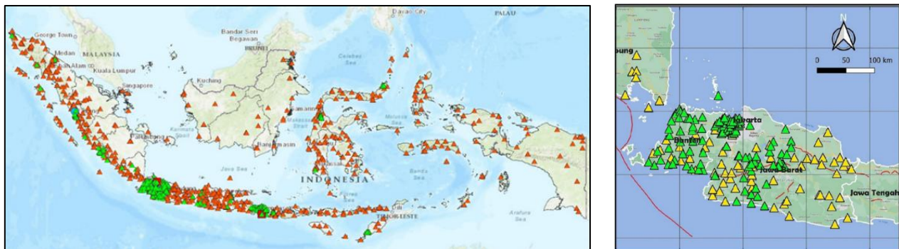
図1 インドネシアの強震・震度(赤・緑)観測点約1000カ所(左)とジャワ島西部の強震・震度(黄・緑)観測点約200カ所(右)
