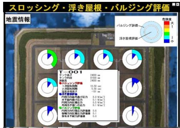
図4 評価結果表示例
